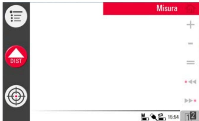
3. Per puntare il primo punto, ad esempio, un angolo, premere
